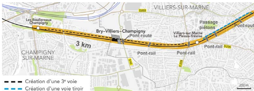
Figure 3 : schéma des aménagements à modifier le long du tracé de la voie ferrée existante (Source dossier)
